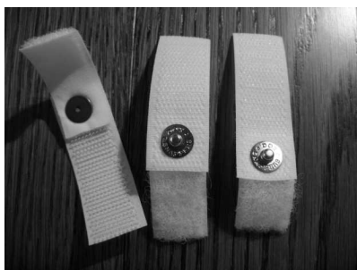
Zdjęcie 2. a) elektrody GSR wielorazowego użytku b) sposób podłączenia elektrod podczas wykonywania badania GSR
