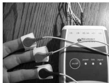
Zdjęcie 2. a) elektrody GSR wielorazowego użytku b) sposób podłączenia elektrod podczas wykonywania badania GSR
