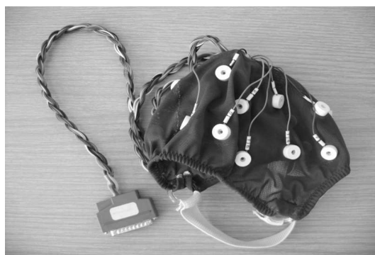
Zdjęcie 1. Czepek automatyczny do EEG firmy ELMIKO – 20 elektrod cynowych wbudowanych na zewnątrz Fot.: Barbara Wąsikowska
